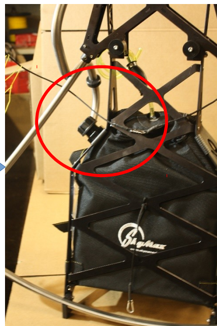
Положение карабина стяжки сетки ограждения после переноса на сторону двигателя
