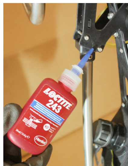
Обработка резьбы крепежных болтов нижнего луча
