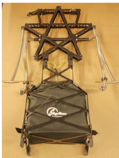
Соединение верхней и нижней части рамы «Звезда»
