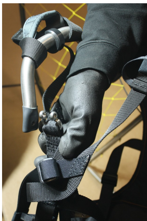
Петля подвески, продетая в омега-образную скобу
