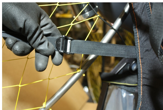
Петля подвески, продетая в омега-образную скобу
