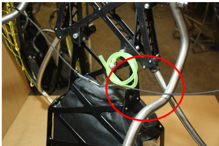
Положение карабина стяжки сетки ограждения после ее установки на лучи.
