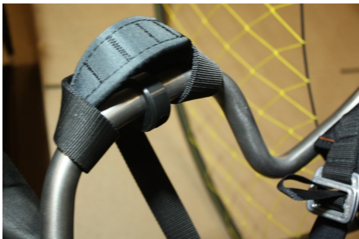
Фиксация основной петли подвески на роге
