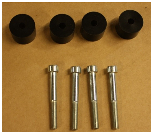
Комплект болтов М8 и проставок для крепления двигателя Moster 185
