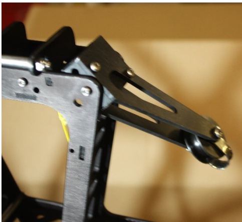
Транспортное положение ролика ручного стартера
