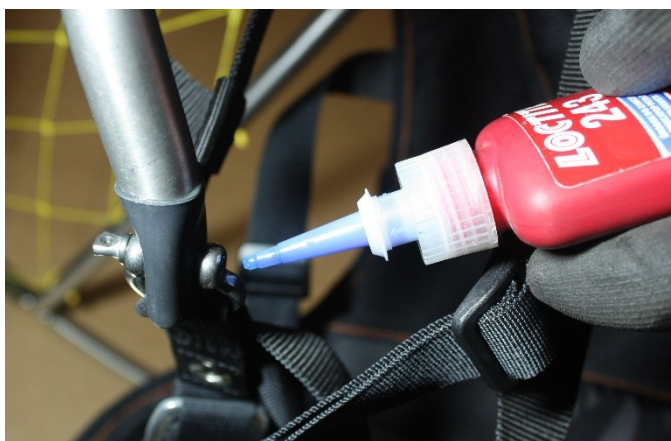
Фиксация резьбы в омега-образной скобе
