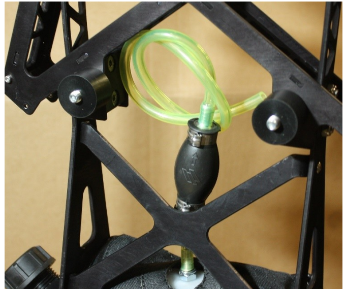
Крепежные болты для двигателя с проставками
