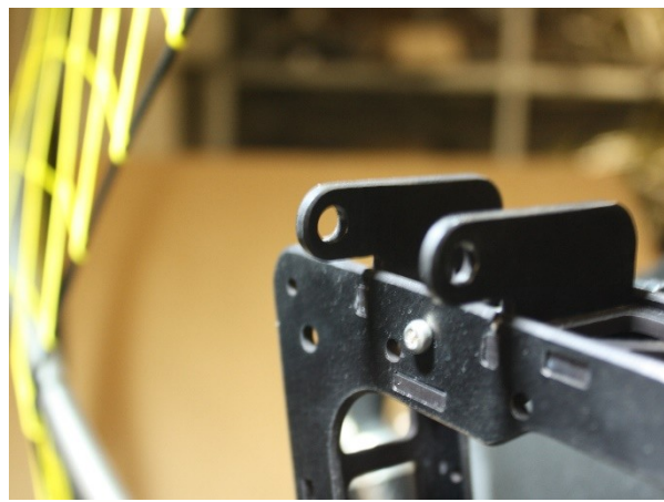
Верхнее крепление подвески со снятой «шпилькой»
