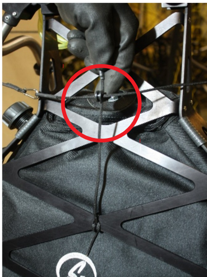
Пропустите тросик-натяжитель через ролик на стяжке сетки
