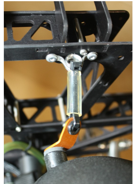
Крепление airbox к раме «Звезда»
