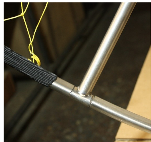
Крепление сетки на нижний луч
