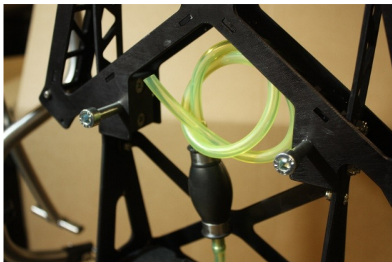
Соединение верхней и нижней части рамы болтами М8
